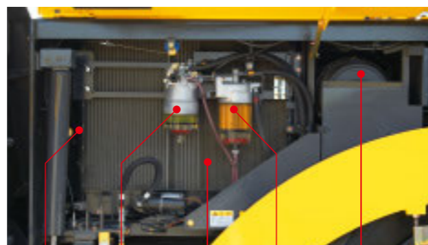
オイルクーラ 燃料フィルタ ラジエータ 燃料プレフィルタ エアクリーナ
