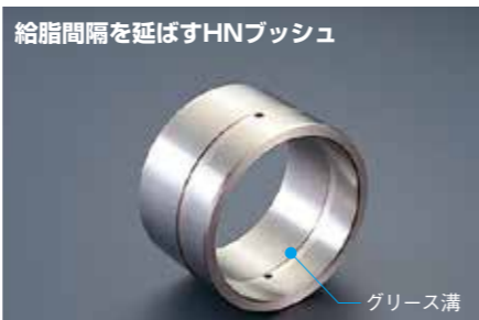
作業機ジョイント部に潤滑特性に優れたHNブッシュを採用し給脂間隔を250時間としました。<注>稼働開始から50時間までの給脂間隔は取扱説明書に従ってください。
