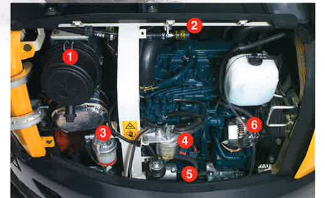
1. エアクリーナ 2. インジケータ 3. ウォータセパレータ 4. 燃料フィルタ 5. スタータモータ 6. オルタネータ
