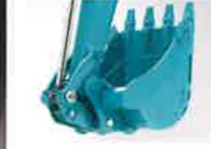
ワイヤーロープ外れ止め金具付格納型フックを採用
